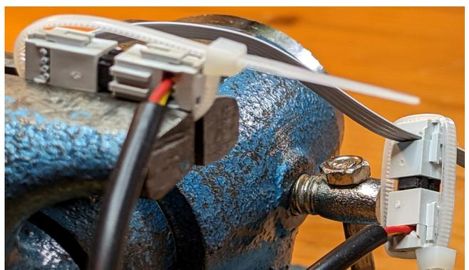
Der 6. Temperatursensor an der Zuleitung kann in kurzer Form innen in einer Wabengasse oder in langer Form aussen sein.
